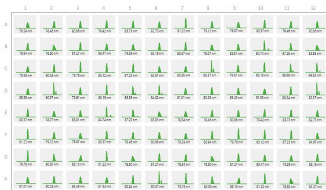
図4: StunnerのDLSは、約1時間で96サンプルのLNPサイズおよびサイズ分布を決定します。
